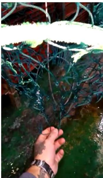
**Figura 6.** Fotografía que muestra la malla adicional incluida para cerrar el cono durante el virado y el monofilamento al centro que acciona el mecanismo de cierre (Fuente: IFOP).
