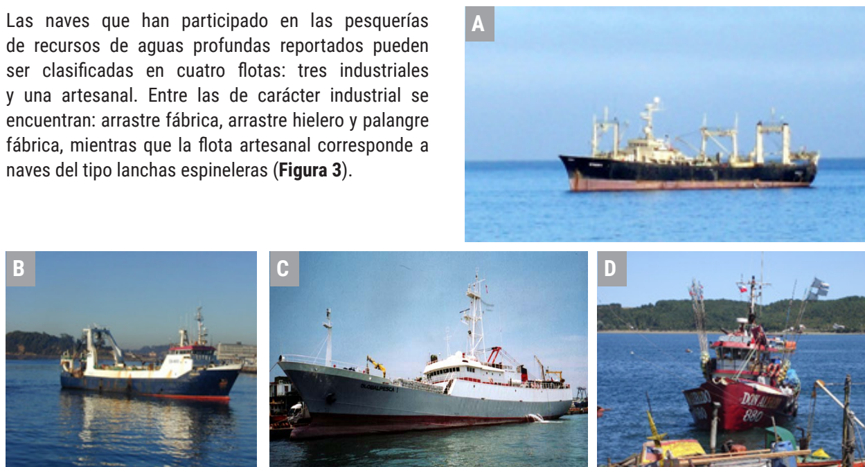
Figura 3. Flotas monitoreadas: a) Arrastre fábrica congelador, b) Arrastre fábrica surimero, c) Palangre fábrica bacaladero y d) Lancha artesanal bacaladera.
